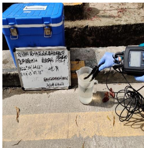
地下水成井洗井现场参数测量
