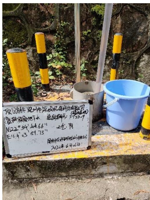
地下水采样前洗井
