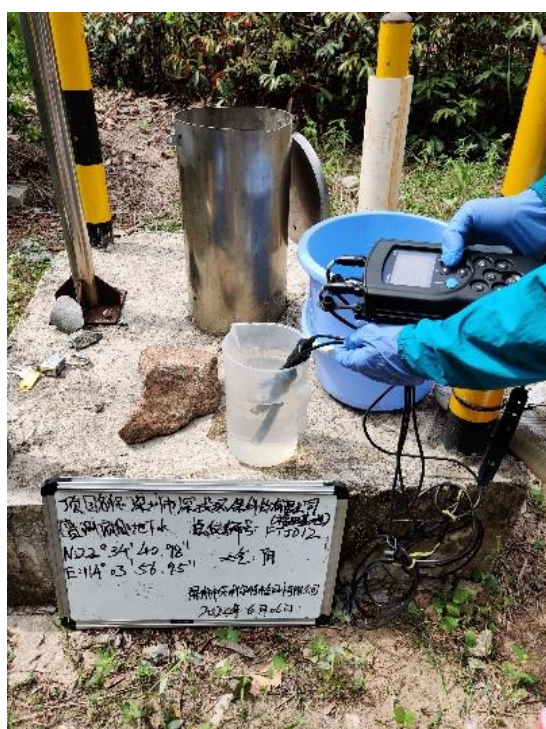
地下水成井洗井现场参数测量
