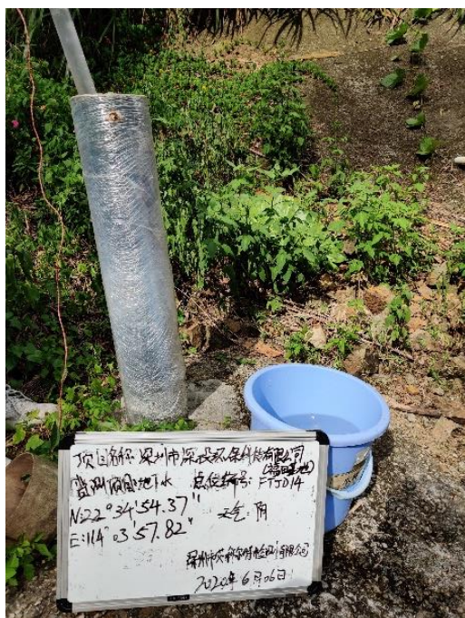
地下水采样前洗井
