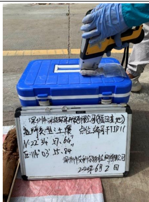
XRF 现场检测
