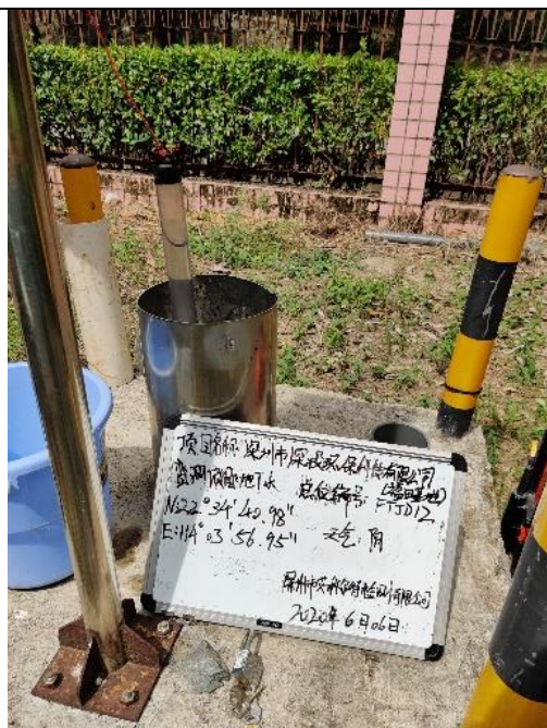
地下水采样前洗井
