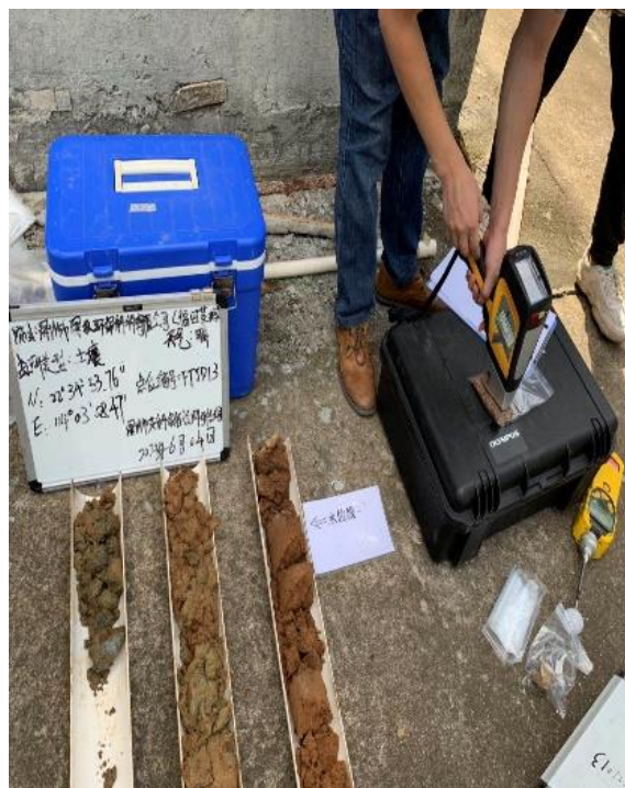
PID、XRF 现场检测
