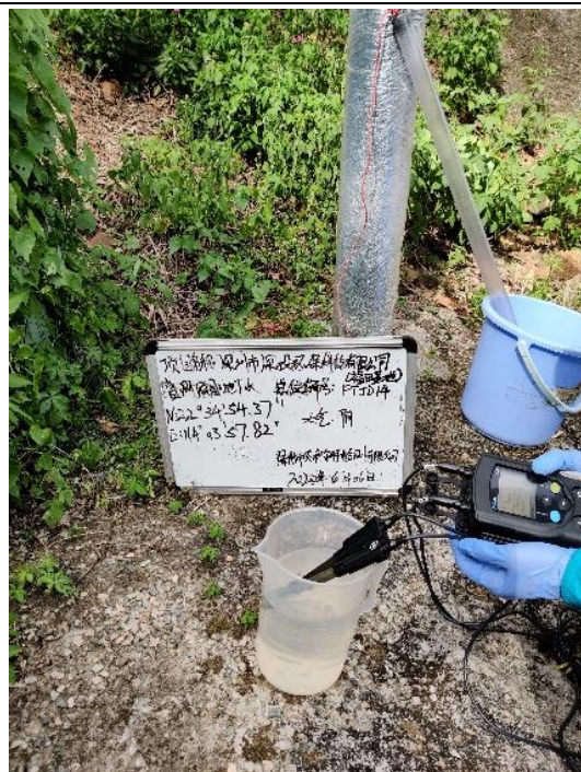
地下水成井洗井现场参数测量
