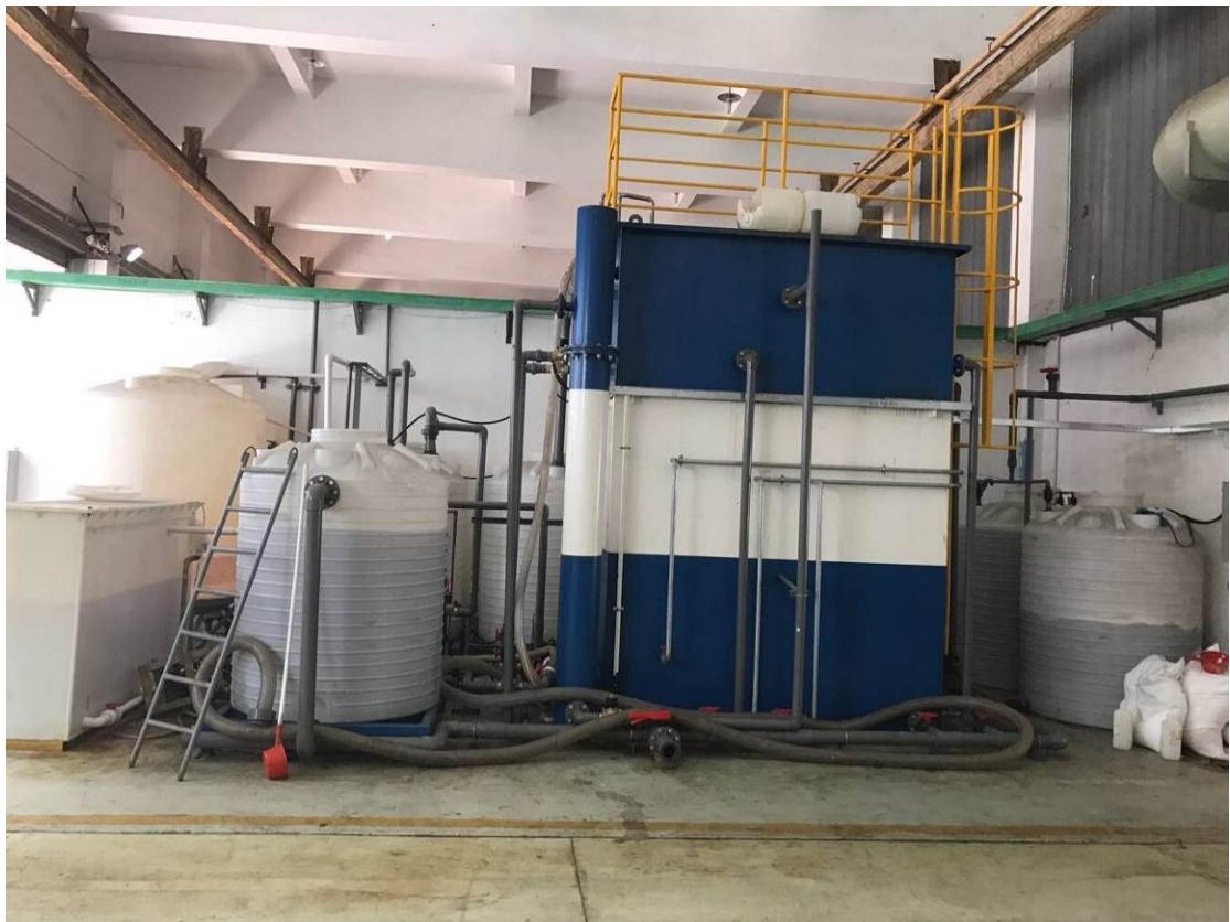
图 8.2-3 废水处理实验装置
