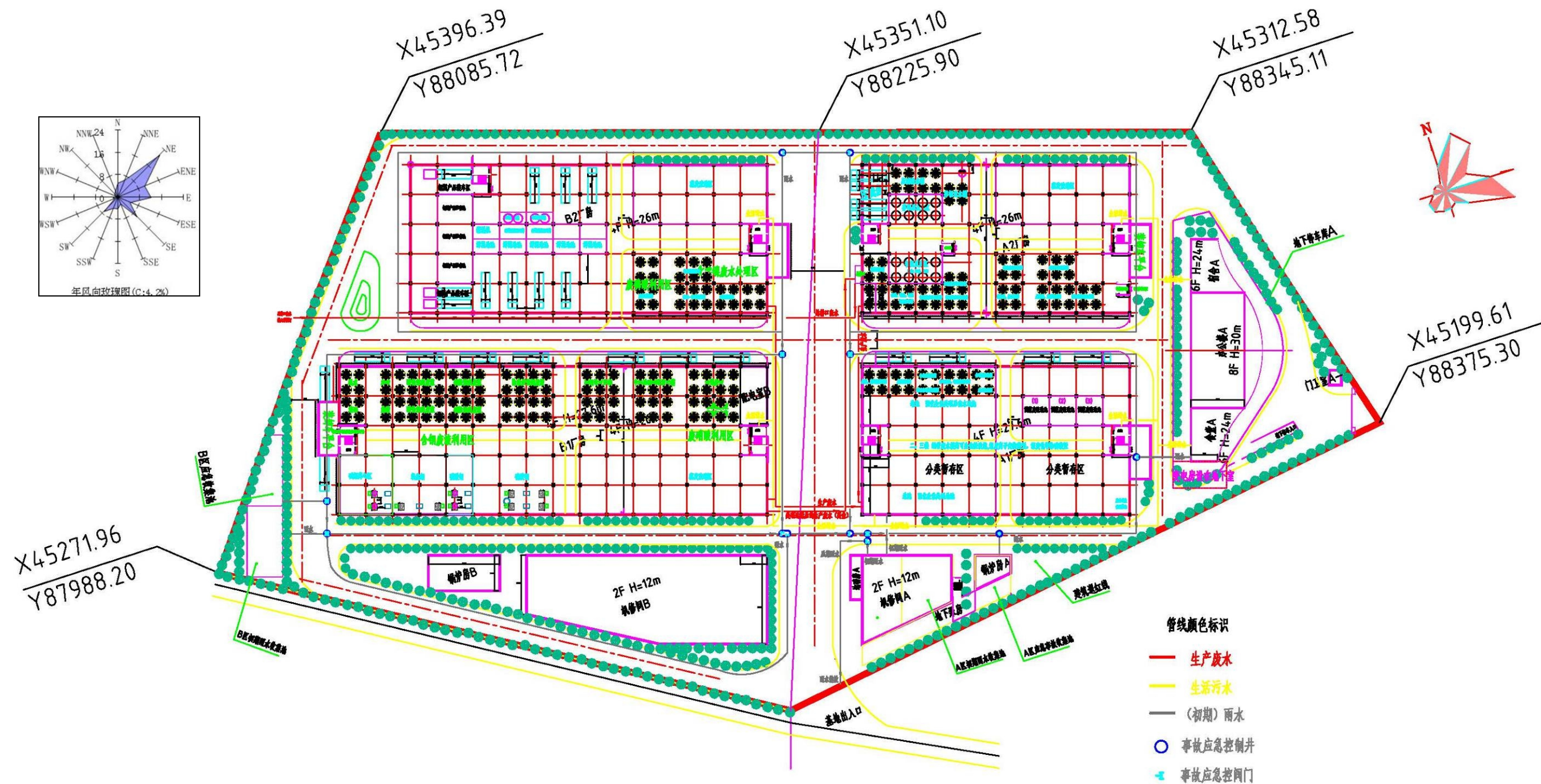
宝安环境治理技术应用示范基地雨污分流管网图
